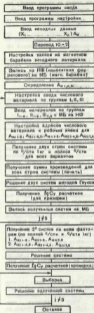
Фиг. 2. Блок-схема решения основной части программы задачи по определению множественной корреляционной зависимости себестоимости изготовления станков от производственно-технологических параметров
