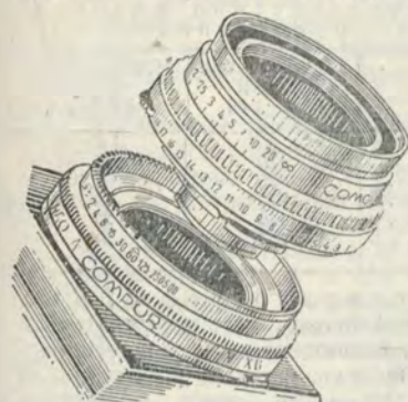
Рис. 5. Центральный затвор «Синхро-Компур» для сменных объективов.
