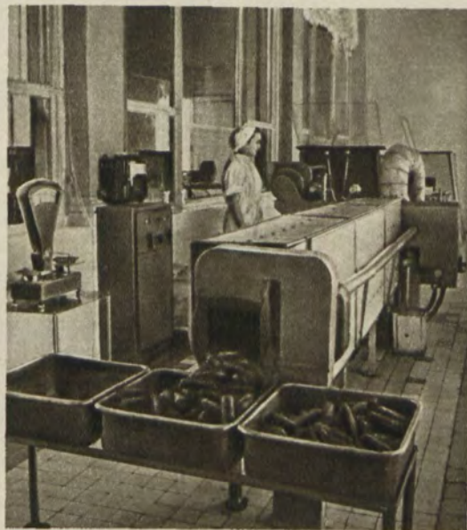
Общий вид пирожкового автомата.
