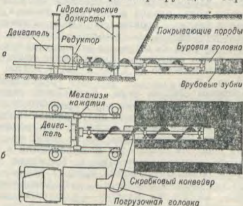
Схема добычи угля шнеко-буровой машиной в карьере: а — разрез; б — план.
