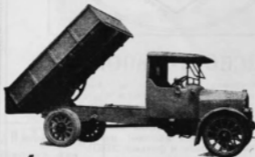
Вспарывающе-выбрасывающие кузова для общественных работ и уборки городских нечистот.
